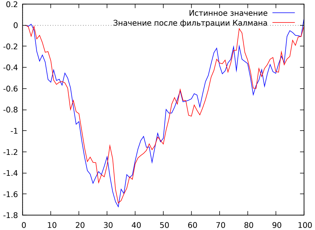
Рис. 8: Одна из реализаций фильтрации Калмана для движения вдоль стены по датчику расстояния. Геометрические размеры робота D = 0.05 , K = 0.1 , a = 0.15 . Скорости вращения колес \omega_L = 1 , \omega_R = 1.01 , шаг по времени dt = 0.1 . Дисперсия \sigma_\xi = 0.1 , \sigma_\eta = 0.2 . Начальные значения: y = 0 , \alpha = 0.01 .
