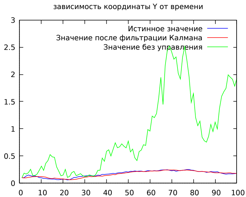
Рис. 10: Моделирование движения вдоль стены. Геометрические размеры робота D = 0.05 , K = 0.1 , a = 0.15 . Начальные скорости вращения колес \omega_R = 1.001 , \omega_L = 1 . Среднеквадратичные отклонения: \sigma_\xi = 0.01 , \sigma_\eta = 0.02 , \sigma_\theta = 0.02 , \sigma_\zeta = 0.01 . При превышении расчетных скоростей вращения колес |\omega_{R,L}| > 1.5 скорость вращения принималась равной \pm 1.5 . Знак совпадал со знаком вращения расчетного значения скорости.
